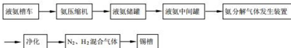
图 3.2-9 氨分解制氢工艺流程图
