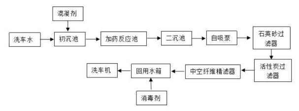
图 1 洗车废水循环水处理工艺
