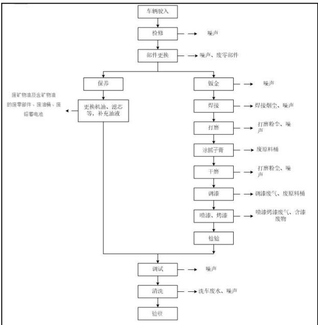
图 4 项目运行期工艺流程及产污环节
