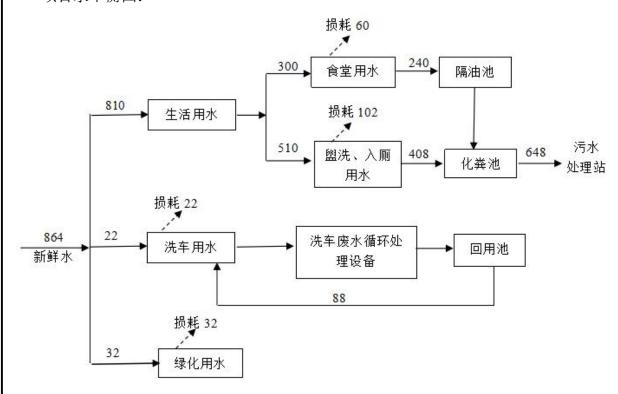
图 2 项目水平衡 m³/a
