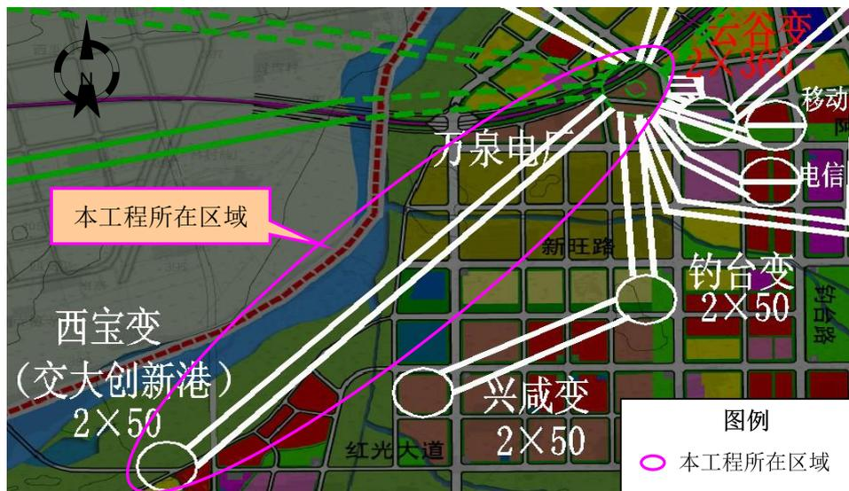
图 1-1 工程系统本期接入方案示意图
