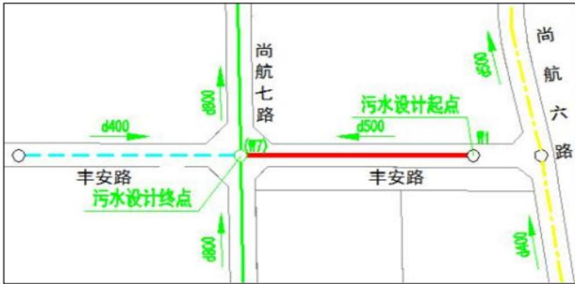
图 4 丰安路（东段）污水管道位置示意图
