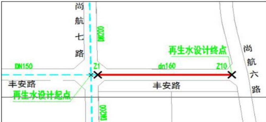
图 5 丰安路（东段）再生水管道位置示意图
