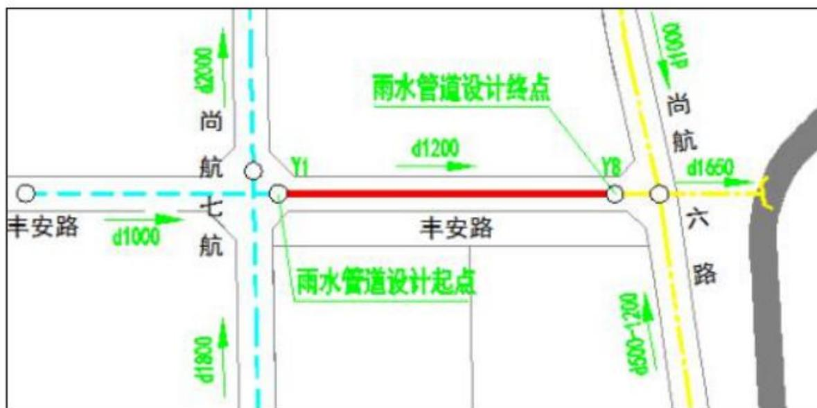
图3 丰安路（东段）雨水管道位置示意图
